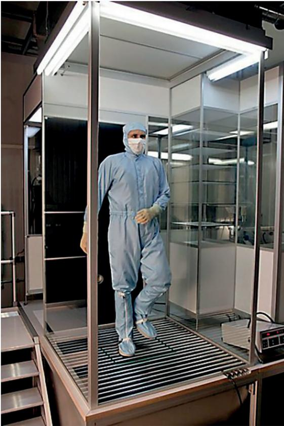
Abbildung 5: Messung der Partikelfreigabe durch den Menschen in der sog. Body-Box (Quelle: dastex).
